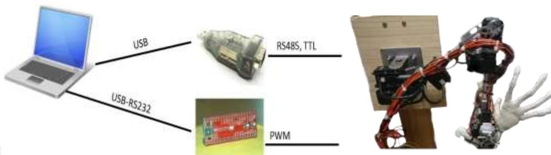
Le bras est manipulé directement par l'ordinateur en utilisant le Dynamixel <sup>[2]</sup> pour transformer les signaux USB en signaux RS485 et TTL qui sont utilisés par les servomoteurs du bras. Nous avons besoin d'un central de communication (ordinateur) pour effectuer les calculs concernant le bras.
